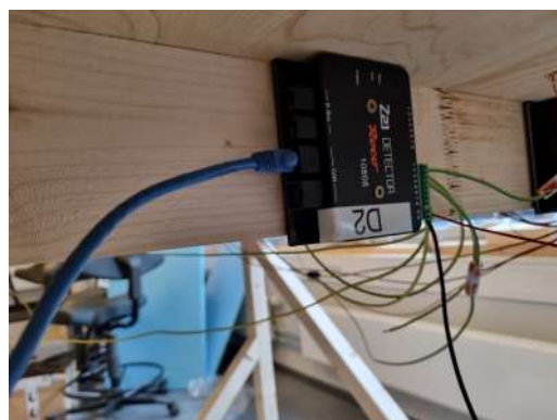
Figur 18: Jord, spenning og CAN må kobles mellom modulene.
